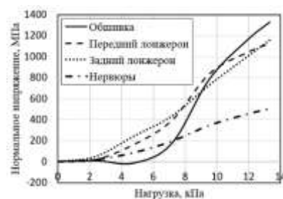
Рисунок 14. Распределение напряжений всех силовых элементов двухлонжеронного крыла из углепластика, при критической нагрузке
