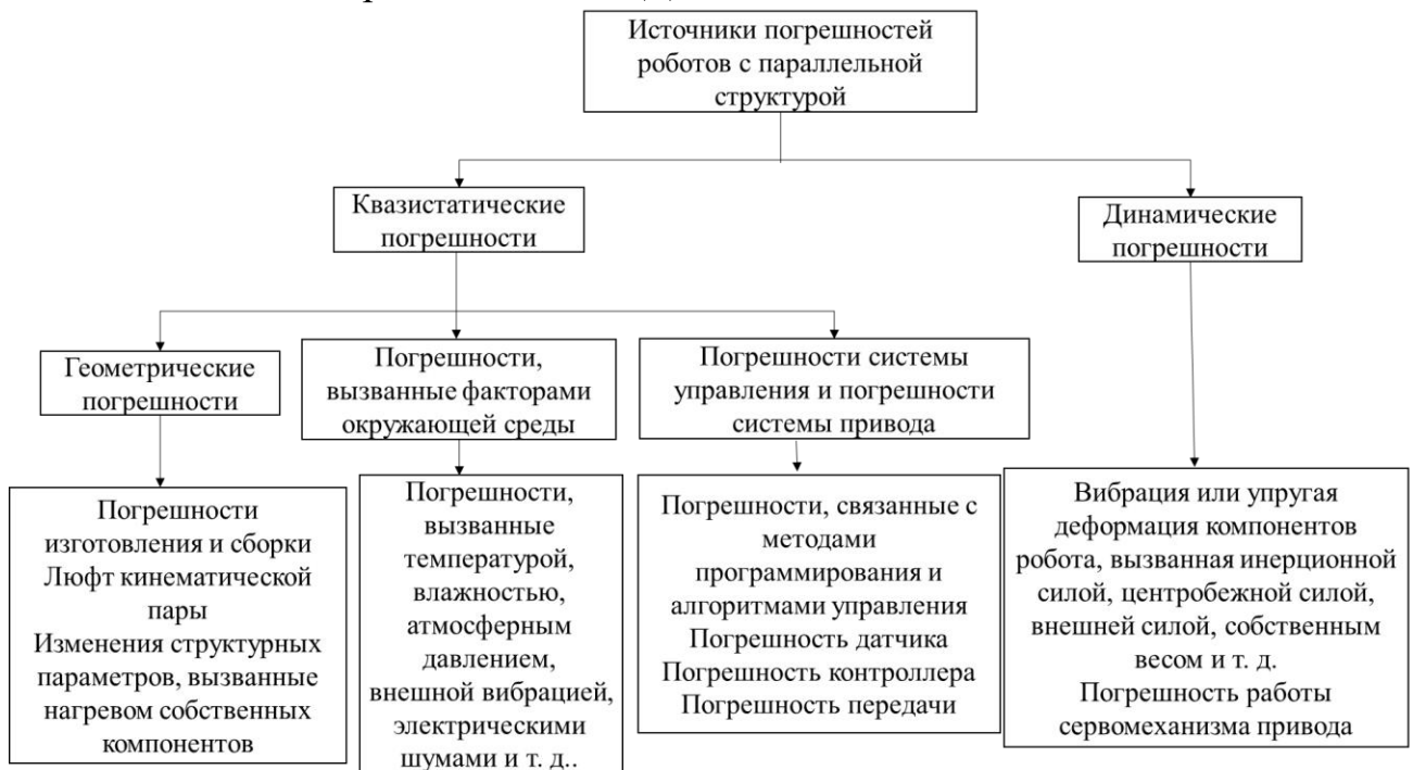
Рис. 1. Источники погрешностей роботов с параллельной структурой
