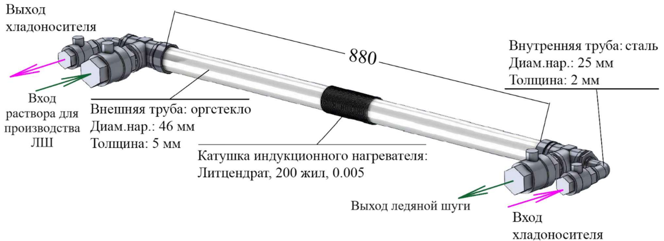
Рисунок 3. Экспериментальный участок лабораторного генератора шугообразного льда
