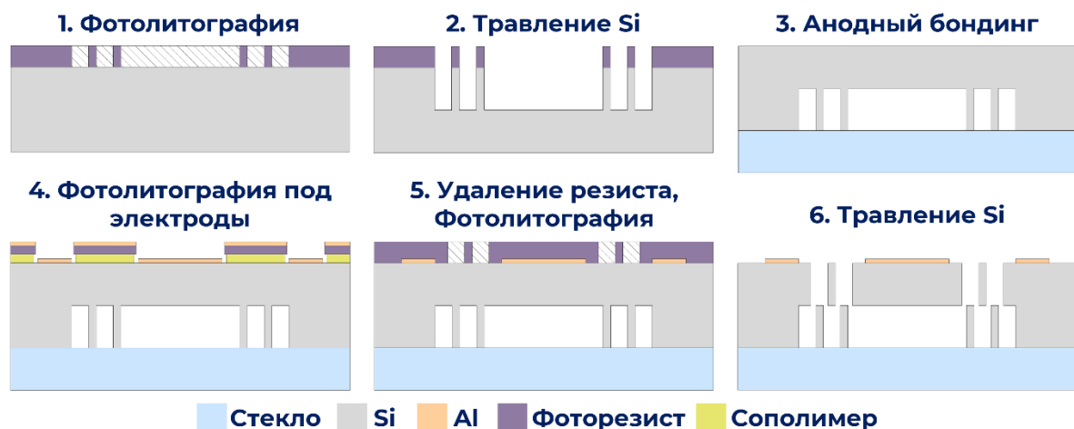
Рисунок 5. Предложенный базовый МТП для создания МЭМС/МОЭМС на встречно-штыревых структурах
