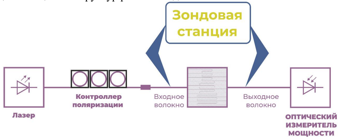
Рисунок 16. Схема измерения потерь оптической мощности в ФИС
