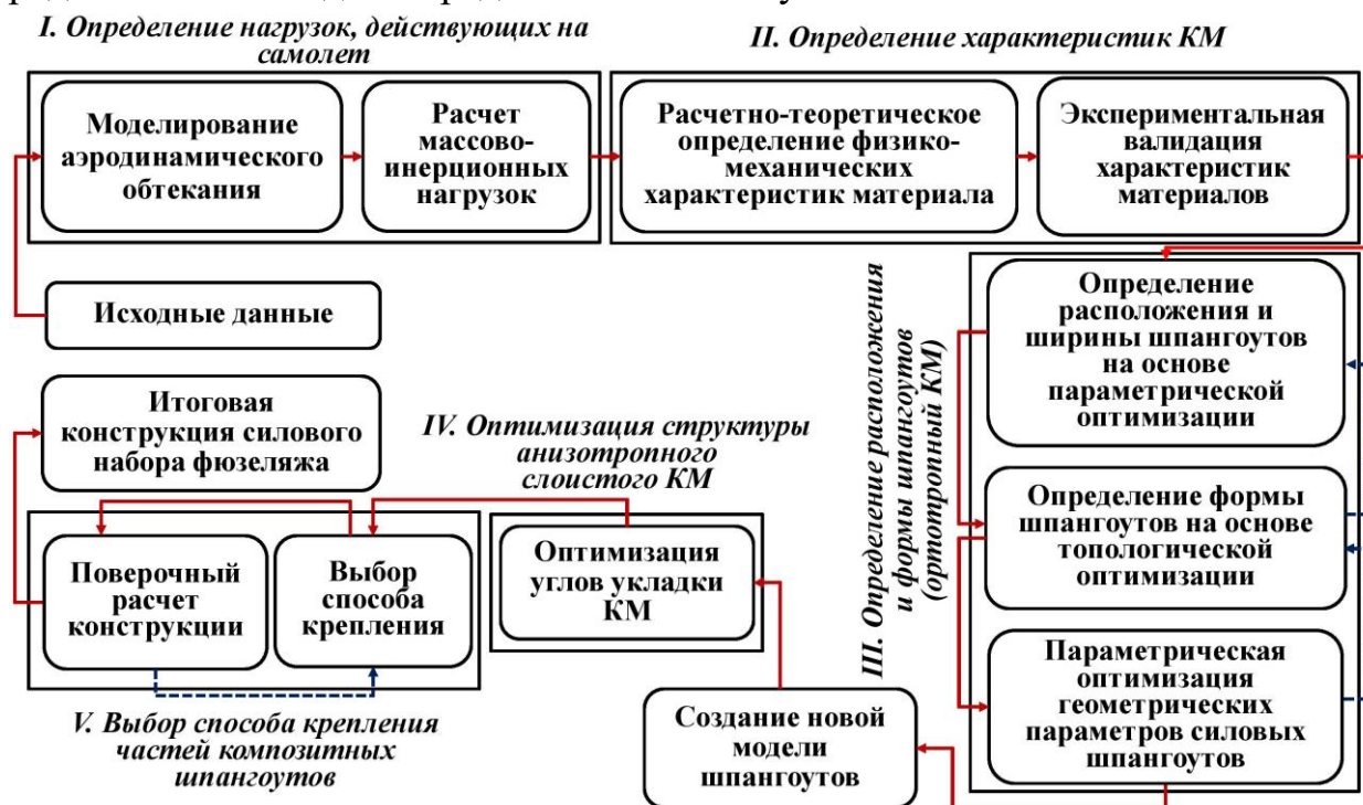
Рисунок 1. Общая схема методики выбора параметров композитного силового набора хвостовой части самолета
