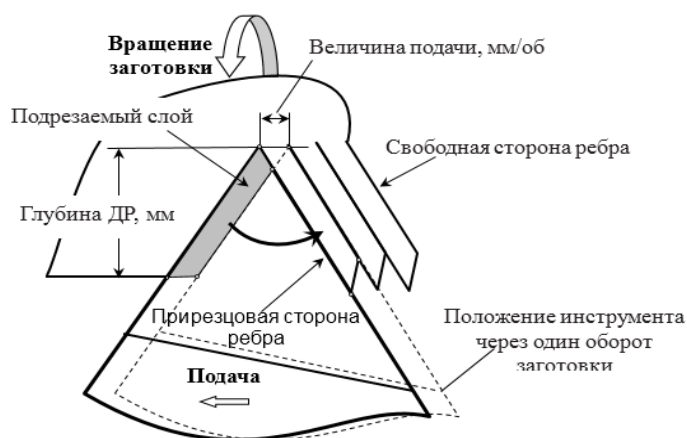
Рис.3. Схема формирования оребрения без зазора методом ДР
