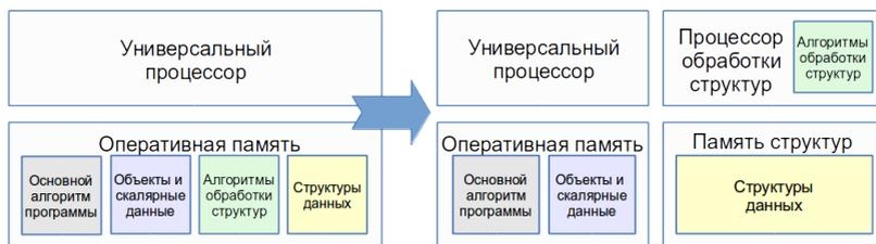
Рисунок 2 — Универсальная ЭВМ, построенная по базовым принципам Фон-Неймана (слева) и вычислительная система с аппаратной поддержкой операций над множествами и структурами данных (справа)
