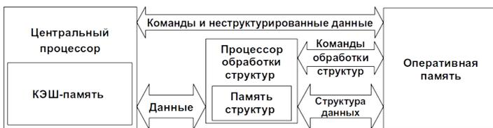
Рисунок 3 — Взаимодействие устройств в вычислительной системе с аппаратной поддержкой операций над множествами и структурами данных
