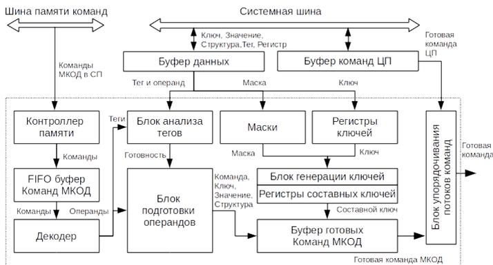
Рисунок 9 — Структура устройства выборки команд
