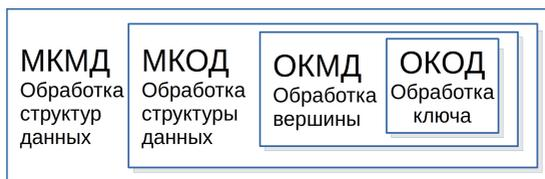
Рисунок 4 — Принцип иерархической вложенности архитектур вычислительных систем
