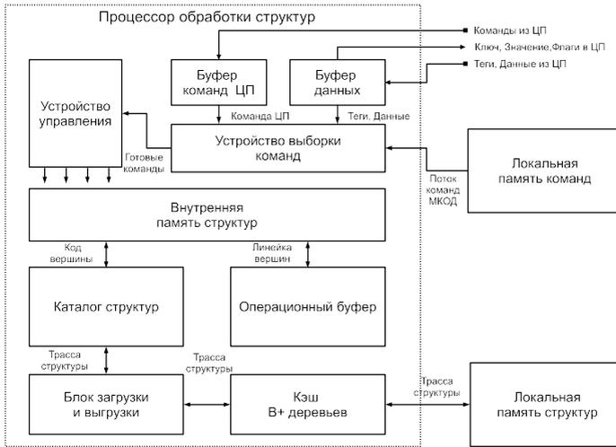
Рисунок 6 — Подсистемы процессора обработки структур единицы (нулевой, служебной структуры). *Каталог* является уникальным аппаратным устройством, реализованным впервые. В каждой вершине *Каталога* хранится следующая информация:
