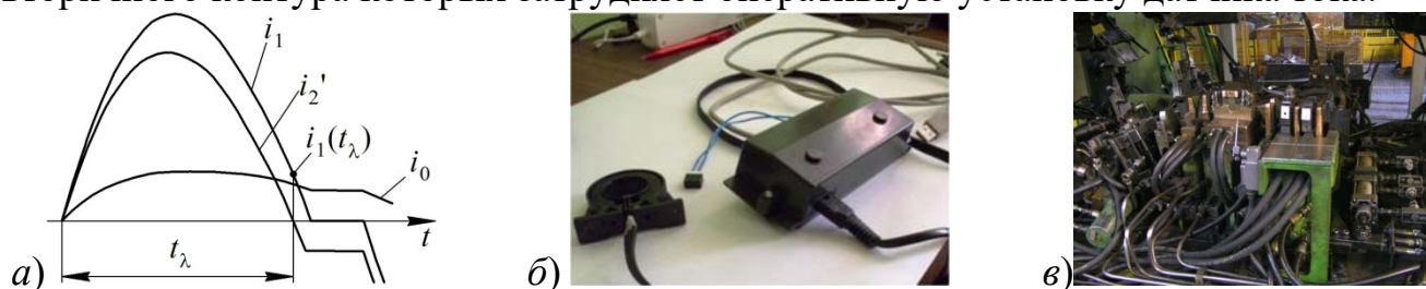
Рисунок 5. Диаграммы мгновенных значений токов при контактной сварке (а), измеритель сварочного тока (б) и контур многоэлектродной сварочной машины (в)
