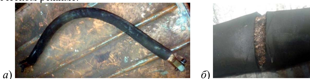
Рисунок 32. Внешний вид (а) и частичное разрушение токоведущей части (б) гибкой неохлаждаемой перемычки сечением 300 мм 2
