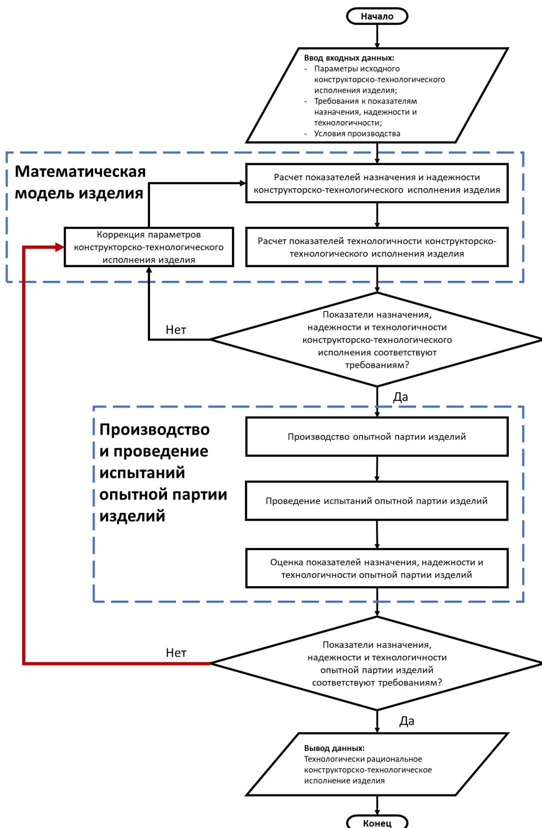
Рисунок 1. Алгоритм обеспечения технологической рациональности конструкции СМЧ
