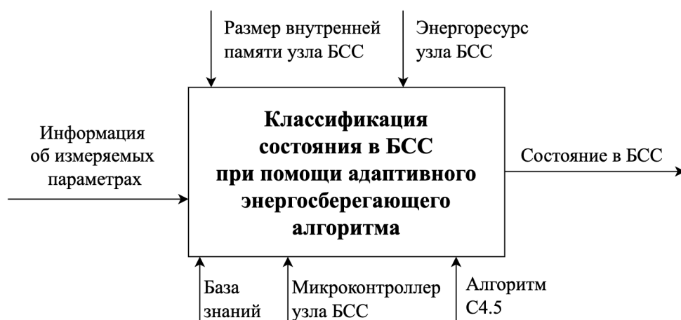
Рисунок 5. Контекстная диаграмма работы адаптивного энергосберегающего алгоритма классификации состояний в БСС
