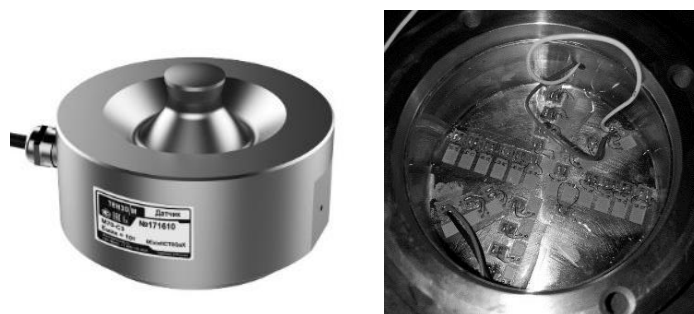
Рисунок 5. Экспериментальное определение НДС датчика М70-30
