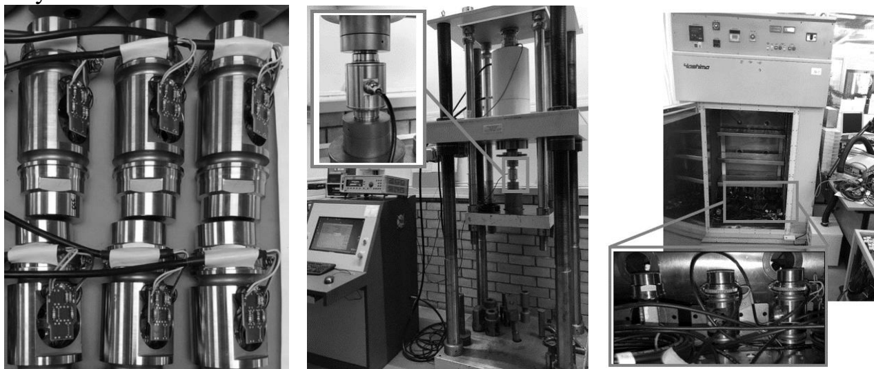
Рисунок 12. Изготовление и испытания опытной партии датчиков МБК-20
