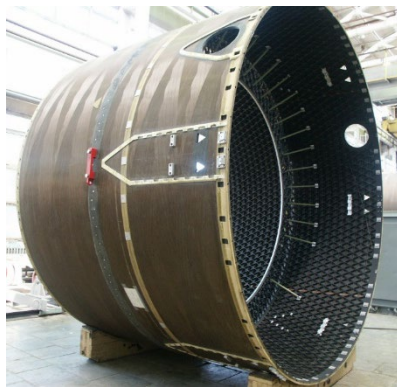
Рис. 4. Композитный сетчатый отсек РН Протон-М
