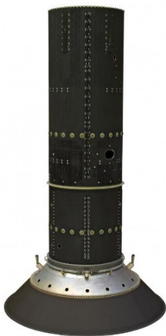
Рис. 1. Центральная силовая труба платформы Spacebus (RUAG)
