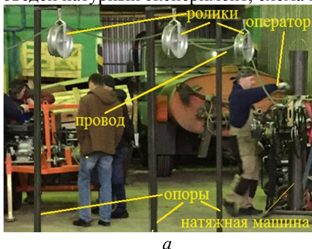
Рисунок 6. Натурный эксперимент: а - установка и б – результаты натурного эксперимента для 2-х опор: график 0 – данные проектировщиков (совпадают с графиком 1), график 1 – данные моделирования, график 2 – данные натурного эксперимента, a_1 , a_2 – расстояния от нижней точки провода в каждом пролете до горизонтальной оси
