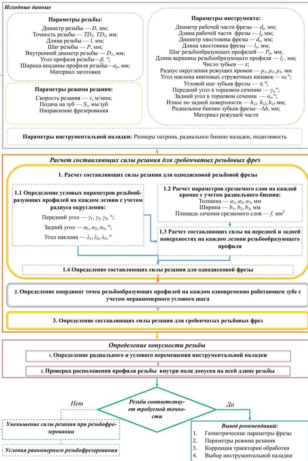
Рисунок 2. Система расчета конусности резьбы с использованием моделирования силы резания при резбофрезеровании
