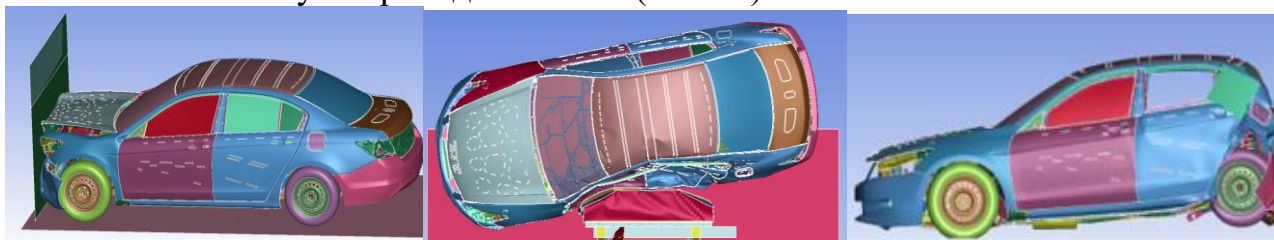
Рис. 13. Результаты расчетов автомобиля Honda Accord при фронтальном, боковом столкновениях и ударе сзади
