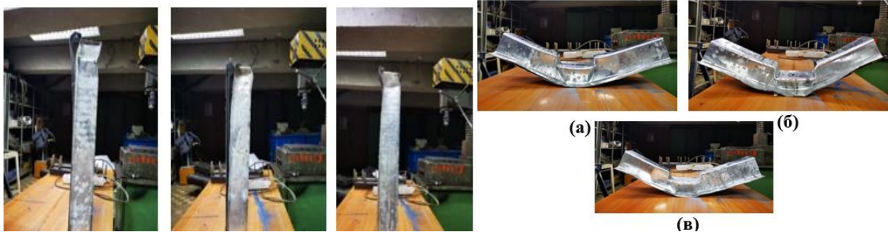
Рис. 1. Образцы после испытаний при осевой и боковой ударных нагрузках
