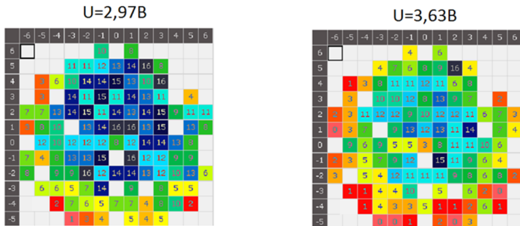
Рис. 8. Распределение кристаллов с работающими банками памяти на пластине при различных напряжениях питания
