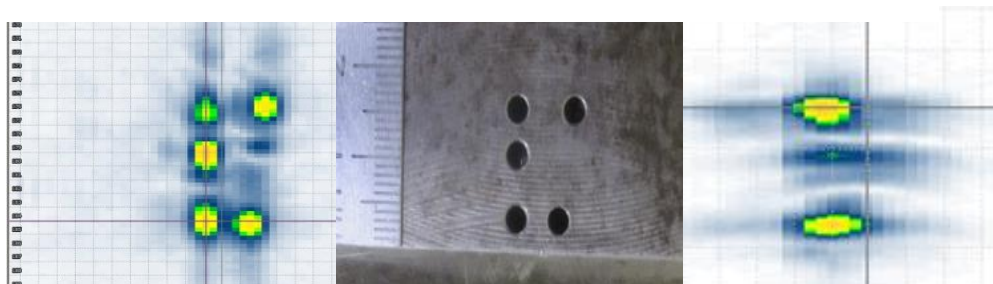
Рис. 6. Изображения плоскодонных отверстий (фото в центре) расположенных на глубине 200 мм, полученные методом 3D-ЦФА (слева) и 2D-ЦФА (справа)
