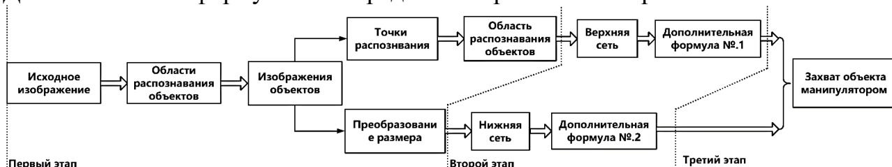
Рис. 5. Универсальная схема захвата объектов с использованием разработанной параллельной сверточной сети
