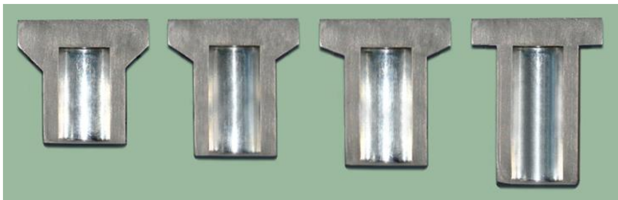
Рис. 13. Выдавленные из алюминиевого сплава АД1 образцы в матрице с R_1=15 мм и углами конусности \gamma=45^\circ, 60^\circ, 75^\circ, 90^\circ
