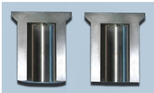
Рис. 17. Полуфабрикат после выдавливания и окончательное изделие после калибровки
