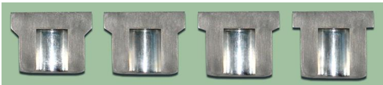
Рис. 12. Выдавленные из алюминиевого сплава АД1 образцы в матрице с R_1=20 мм и углами конусности \gamma=45^\circ, 60^\circ, 75^\circ, 90^\circ
