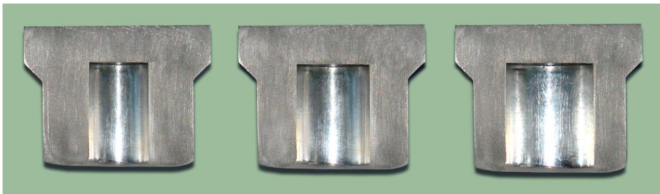
Рис. 5. Выдавленные из алюминиевого сплава АД1 образцы с разным радиусом полости
