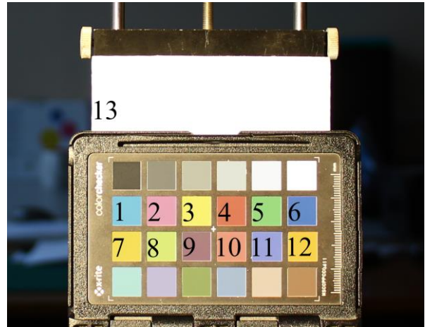
Рисунок 2. Элементы цветовой шкалы X-Rite ColorChecker (1-12) и эталонный объект 13.
