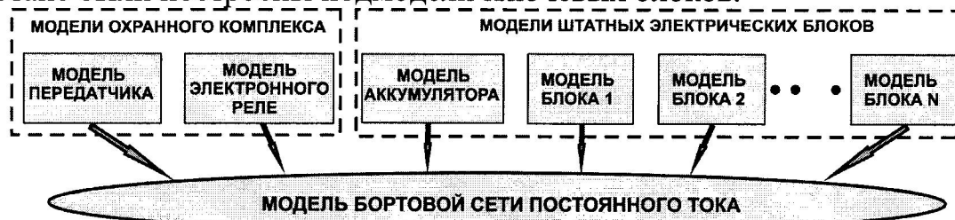
Рис. 5. Структура электрической модели
