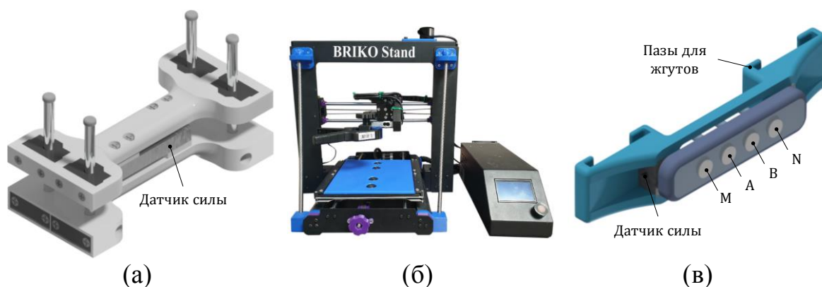
Рисунок 9. Экспериментальное оборудование: стенд изометрического схвата (а), стенд прижатия (б), макет сенсорной системы для регистрации электроимпедансного, электромиографического и миотонического сигналов (в)
