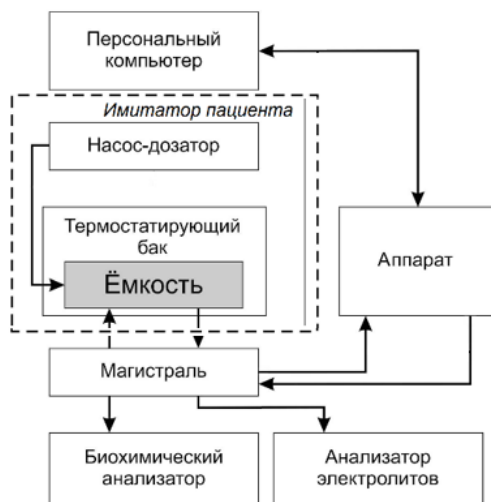
Рисунок 7. Физическая модель биотехнической системы восстановления нарушенной поливариантной системы мочевого выделения
