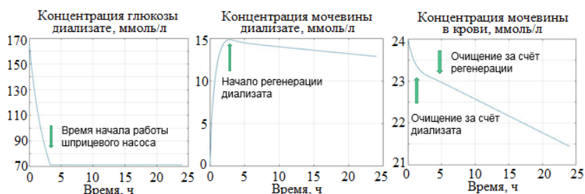
Рисунок 11. Моделирование концентрации глюкозы и мочевины в диализате и крови при диализе с помощью разработанного Аппарата
