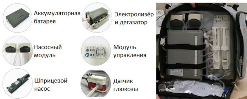
Рисунок 17. Фотография элементов разработанного автономного носимого аппарата для перитонеального диализа и Аппарата в сборе
