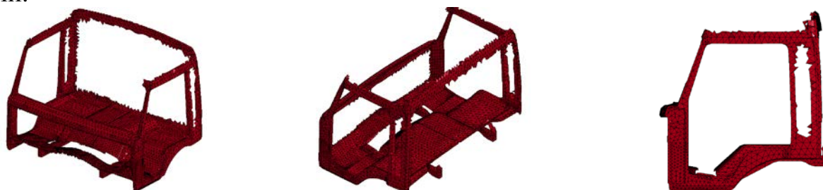
Рис. 12. Результаты топологической оптимизации кабины КАМАЗ
