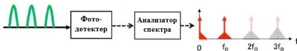
Рисунок 7. Схема стенда для измерения девиации Аллана
