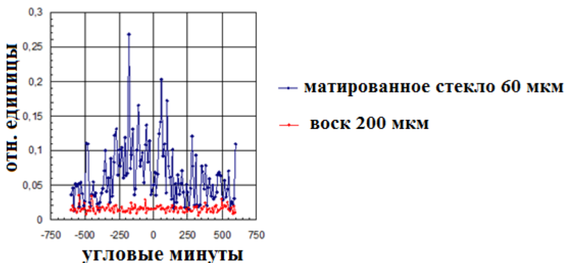
Рисунок 5. Сравнение интенсивности светового потока, прошедшего через классический матовый рассеиватель (синий) и через восковой слой (красный)
