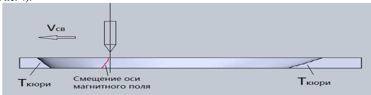
Рис. 4. Схема смещения оси магнитного поля в магнитной пластине
