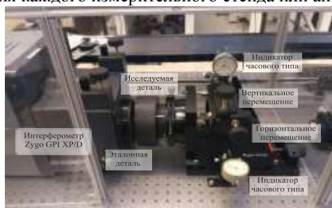
Рисунок 7. Внешний вид стенда для измерения неоднородностей II – III пространственно-частотного диапазона
