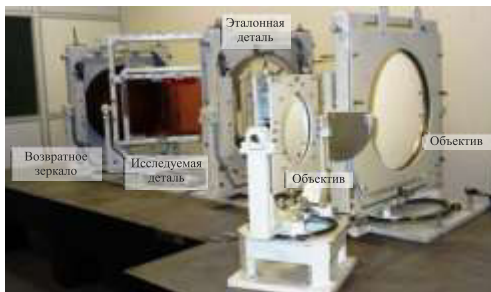
Рисунок 5. Внешний вид аппаратуры контроля качества крупногабаритных оптических поверхностей высокой точности в I-II диапазонах неоднородностей
