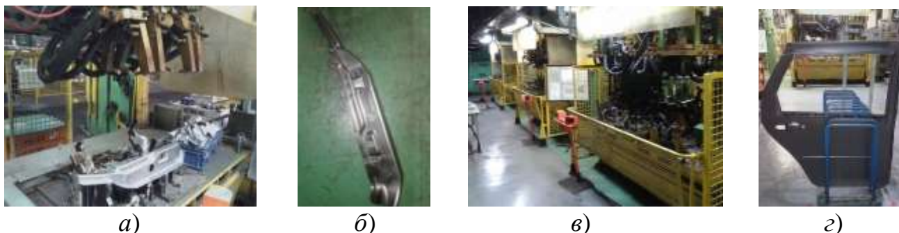
Рисунок 10. Общий вид сварочных машин МСМ 503.618.421 (а) и МСМ 503.651.421 (в), свариваемые на них детали (б и г)
