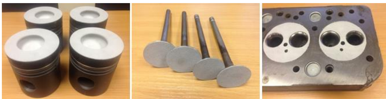
Рис. 2. Поршни, клапаны и головка цилиндра дизеля Д-246.9 (4ЧН 11,0/12,5) с теплоизолирующими покрытиями
