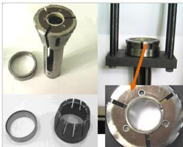
Рис. 11. Специальные зажимы и нагружающие устройства для проведения эксперимента
