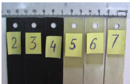
Рис. 2. Образцы №2,3,4 из углепластика, образцы №5,6,7 из стеклопластика
