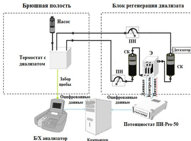
Рисунок 4. Стенд испытания электродных и сорбционных материалов
