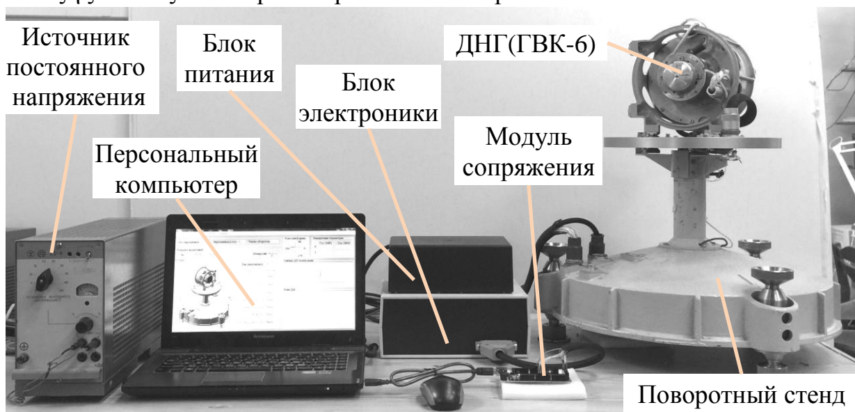
Рис.11. Внешний вид рабочего места для проведения экспериментальных исследований измерительного комплекса «гироскоп – поворотный станд»
