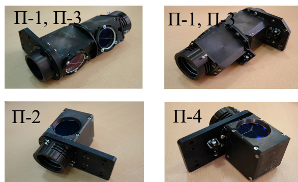
Рис. 4. Конструкция призменного блока опытного образца СОР на основе пентапризм
