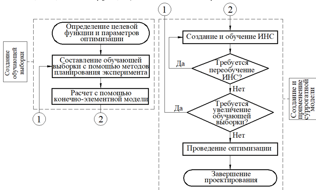
Рис. 18. Блок-схема методики оптимизации с применением суррогатной модели
