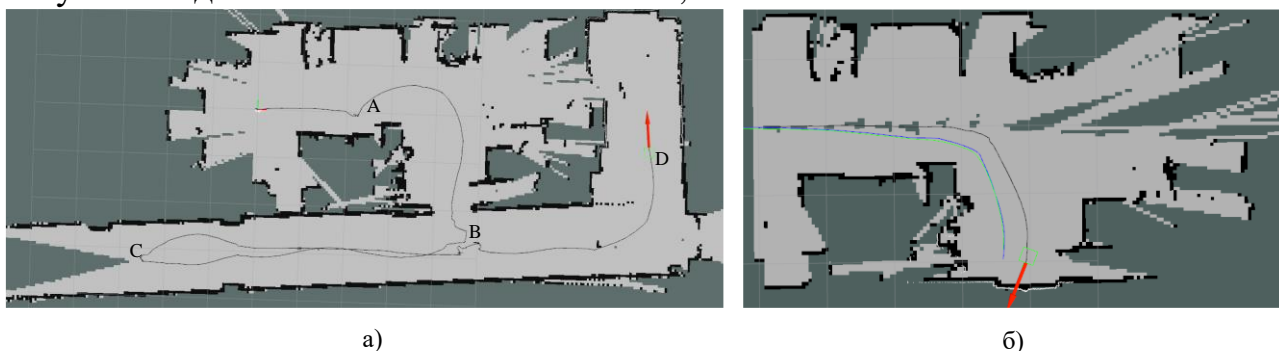
Рис. 16. а) Траектория ведущего робота в построенной карте. б) Траектории роботов R_0 (чёрная), R_1 (синяя) и R_2 (жёлтая)
