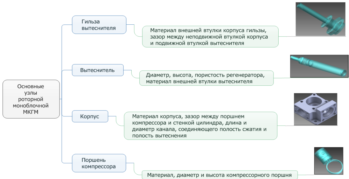
Рисунок 5. Основные узлы роторной моноблочной МКГМ и оптимизируемые конструктивные параметры
