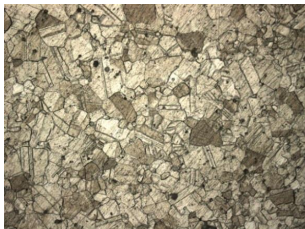
Рис. 13. Микроструктура материала образца в центре сечения. Оптическое увеличение x 200
