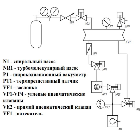
Рисунок 1. Вакуумная схема (а) и внешний вид (б) разработанной установки для проведения экспериментальных исследований
