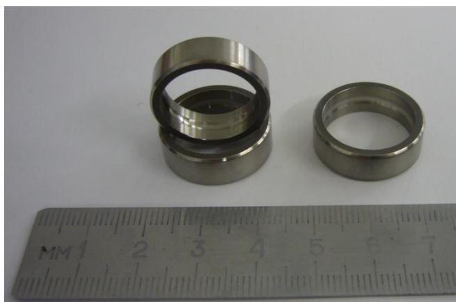
Рис. 1. Кольца приборных парамагнитных подшипников из сплава 40ХНЮ-ВИ, упрочняемых азотированием в целях повышения износостойкости
