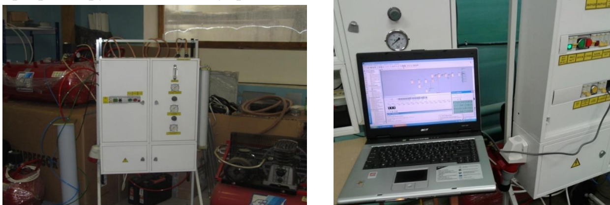
Рисунок 2. а) Общий вид экспериментального стенда; б) блок осушки и автоматики с программируемым блоком управления
