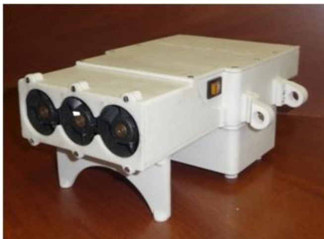
Рисунок 10. Пневмовакуумная установка концентрирования химических растворов.
