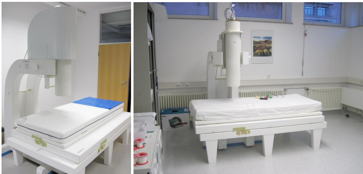
Рисунок 4. Фотографии 12-канального диагностического МКГ-комплекса «МАГ-СКАН-09» с девятью каналами регистрации МКГ и референтным XYZ-магнитометром (в клинике университета г. Тюбинген, Германия)
