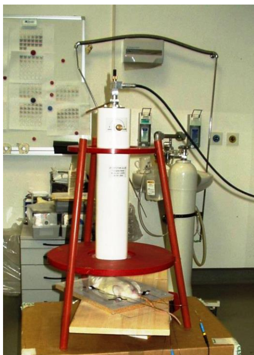
Рисунок 9. Фотография СКВИД-системы, разработанной для исследования МГК малых животных (а). Последовательность карт распределения магнитного поля МГК крысы на QRS-интервале (б)
