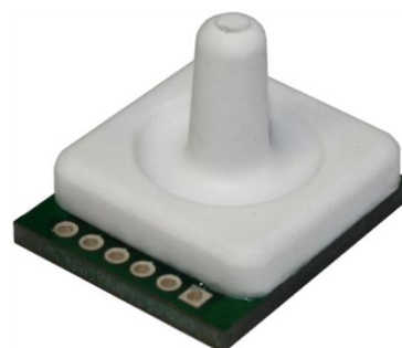
Рисунок 10. Техническая реализация оптических министиков: а) принципиальная схема, б) внешний вид
