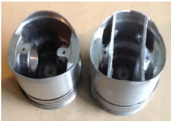
Рисунок 6. Общий вид серийного (слева) и опытного (справа) поршней дизеля 1Ч 8,5/8,0
