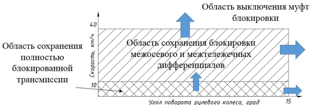
Рис.17. Закон выключения блокировок дифференциалов для колёсной машины 8х8
