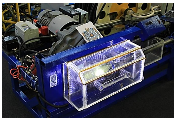
Рис.9. Электромеханический стенд испытания кулачковой муфты
