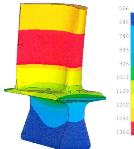
Рис. 12. Тепловое состояние лопатки «Н» на режиме «Взлёт», °C
