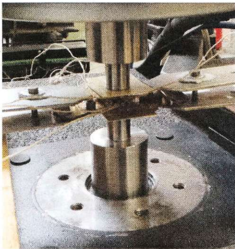
Рис. 8. Проведение термомеханических испытаний
