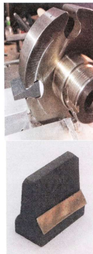
Рис. 15. Модельное рабочее колесо с керамическими лопатками
