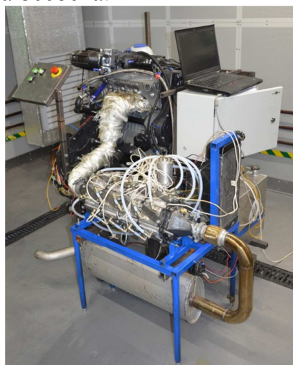
Рис. 12. Схема термоэлектрического генератора, разработанного в МГТУ им. Н.Э. Баумана (слева), установка термоэлектрического генератора на стенд (справа)
