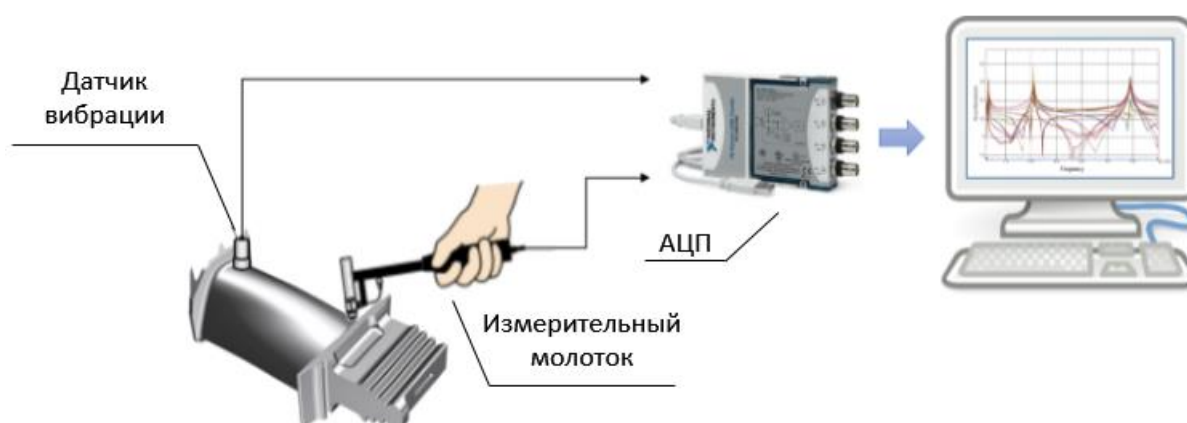
Рис. 3. Схема проведения модальных испытаний заготовки лопатки
