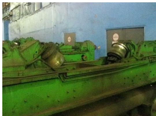
Рис. 4. Моделирование контакта эджерных валков с трубной заготовкой.
