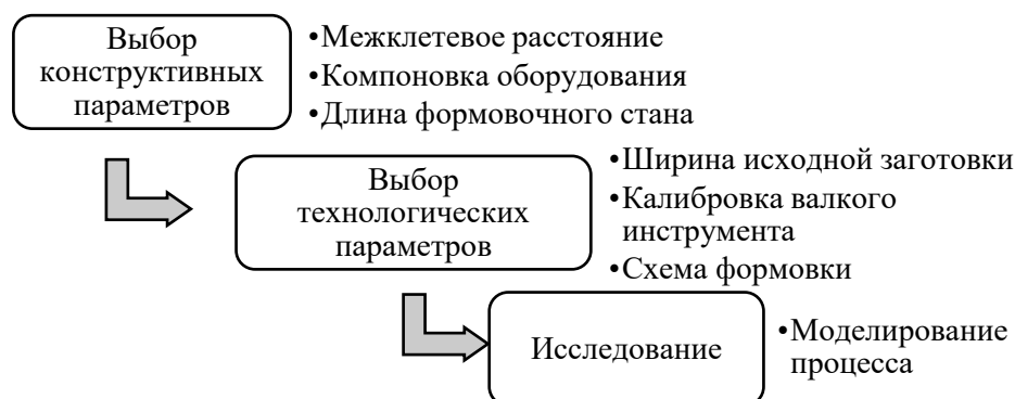
Рис. 12. Последовательность определения параметров процесса формовки
