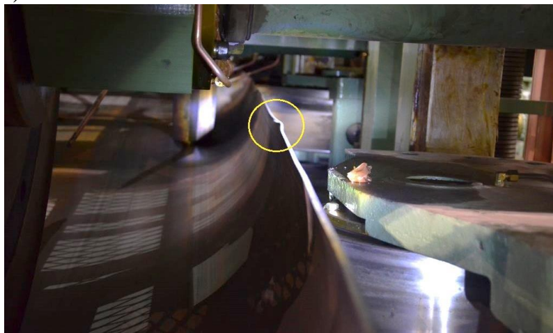
Рис. 6. Излом кромки в межклетевом пространстве BD4 – RVS
